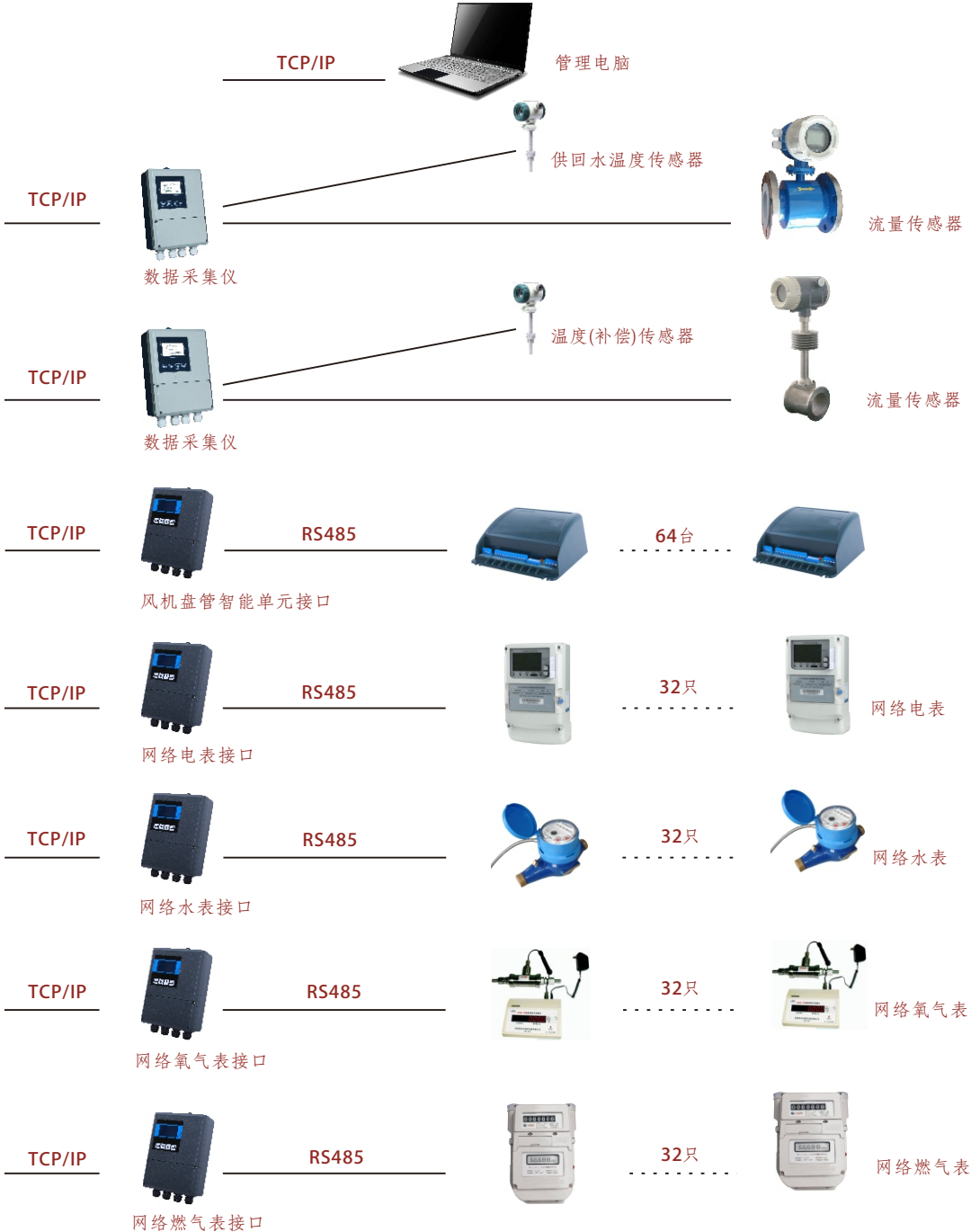
能源综管理系统TCP/IP架构图
